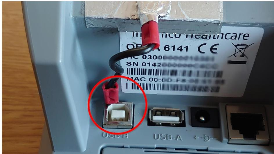
5. Der zweite Kabelschuh wird mit Hilfe des 2 cm schmalen und 4,5 cm breiten Aluminiumstreifen auf dem Aluminiumband der Unterseite so fixiert, dass ein elektrischer Kontakt entsteht.
