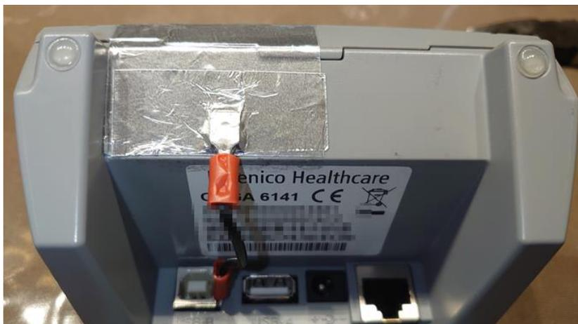
Mit dem zweiten 2 cm Alustreifen oder etwas **Tesa-Film** können Sie den Kabelschuh noch besser stabilisieren und damit verhindern, dass das Alu-Tape zerreißt.
