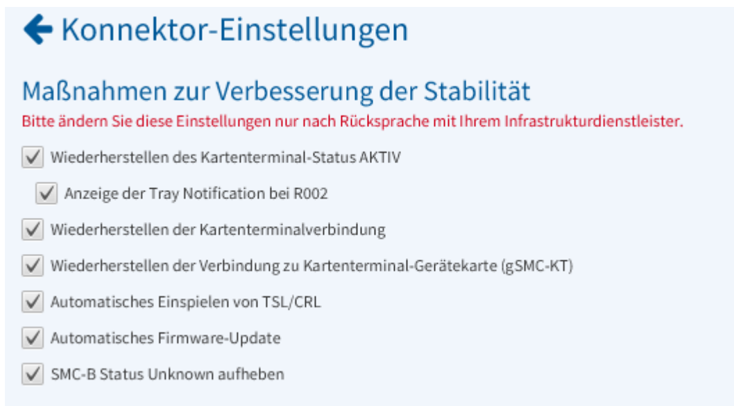
Abbildung 19: Einstellungen zu den Maßnahmen zur Erhaltung der Stabilität für Konnektoren mit Firmwarestand 2.1.x
